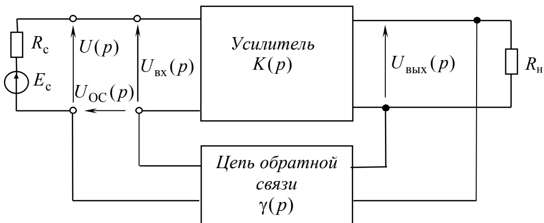
Рис. 2.1 – Структурная схема усилителя с последовательной ОС по напряжению
